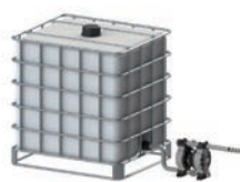
Pompe installée sous la tête (aspiration positive)
