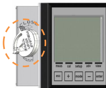
Figure 6 – Unité centrale montée sur le panneau à système de verrouillage escarot
