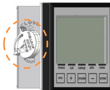
Figure 6 – Unité centrale montée sur le panneau à système de verrouillage escargot
