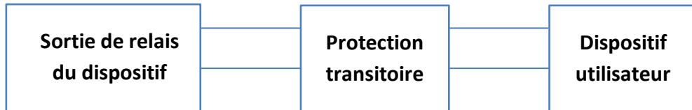
Figure 7 – Protection contre les transitoires
