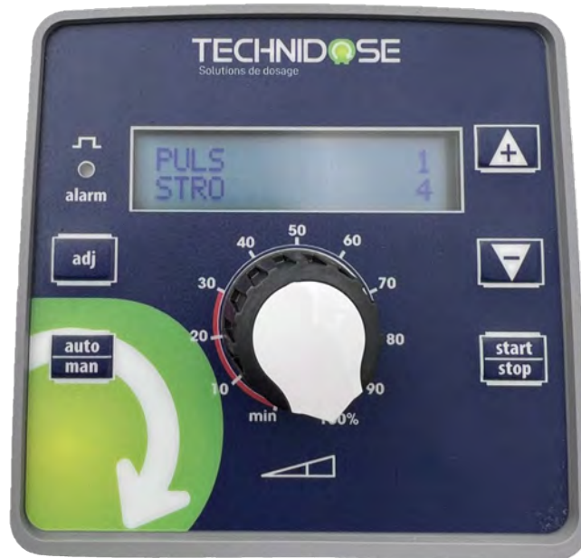
Réglage pompe en mode multiplicateur 1 impulsion contact sec - 4 coups de pompe
