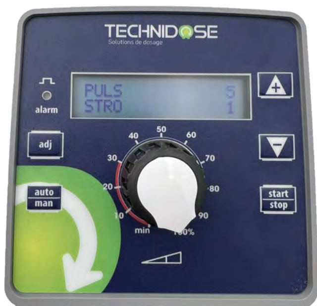
Réglage pompe en mode diviseur 5 impulsions contact sec - 1 coup de pompe
